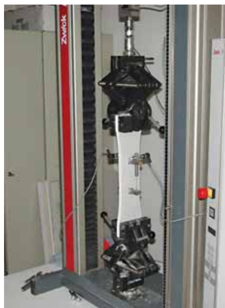
Bild 6 Versuchsaufbau der Zugversuche
