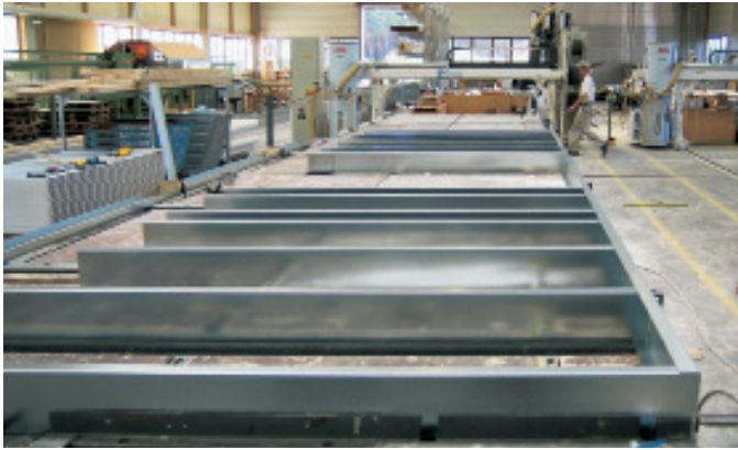
Fügung von Rähm und Ständern auf dem Fertigungstisch
