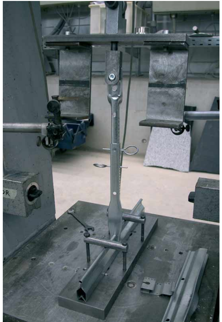
Viel Aufwand. Die Einführung einer neuen europäischen Deckennorm geht einher mit viel Prüfaufwand und führt nicht unbedingt zu größerer Transparenz; im Bild die Bestimmung der Tragfähigkeit eines Deckenabhängers in Verbindung mit einem Klemmprofil (Suckow & Fischer) nach der neuen DIN EN 13964.
